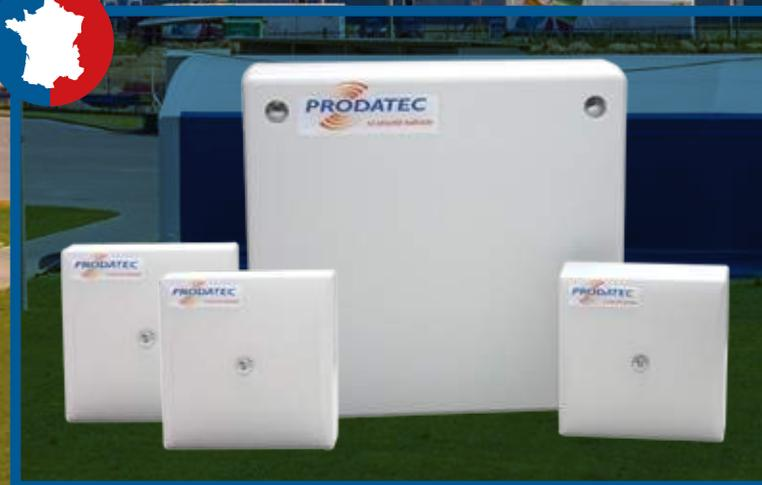
Probus est un système de gestion par bus ouvert de type RS485 avec un protocole de communication propriétaire. Il permet d'interconnecter plusieurs cartes d'entrées (jusqu'à 32 modules équipés de 4 entrées). Le tout relié avec 2 fils (1x2x24AWG) à la carte mère sur des distances maximales de 1200 m.
